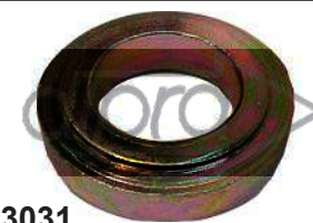
E3031 ALT. T. INDIEL, 100 amp.-ENTRE TAPA Y TURBINA, Med. ALTO 12.2mm.-EJE 17mm., TAUNUS, M.BENZ
